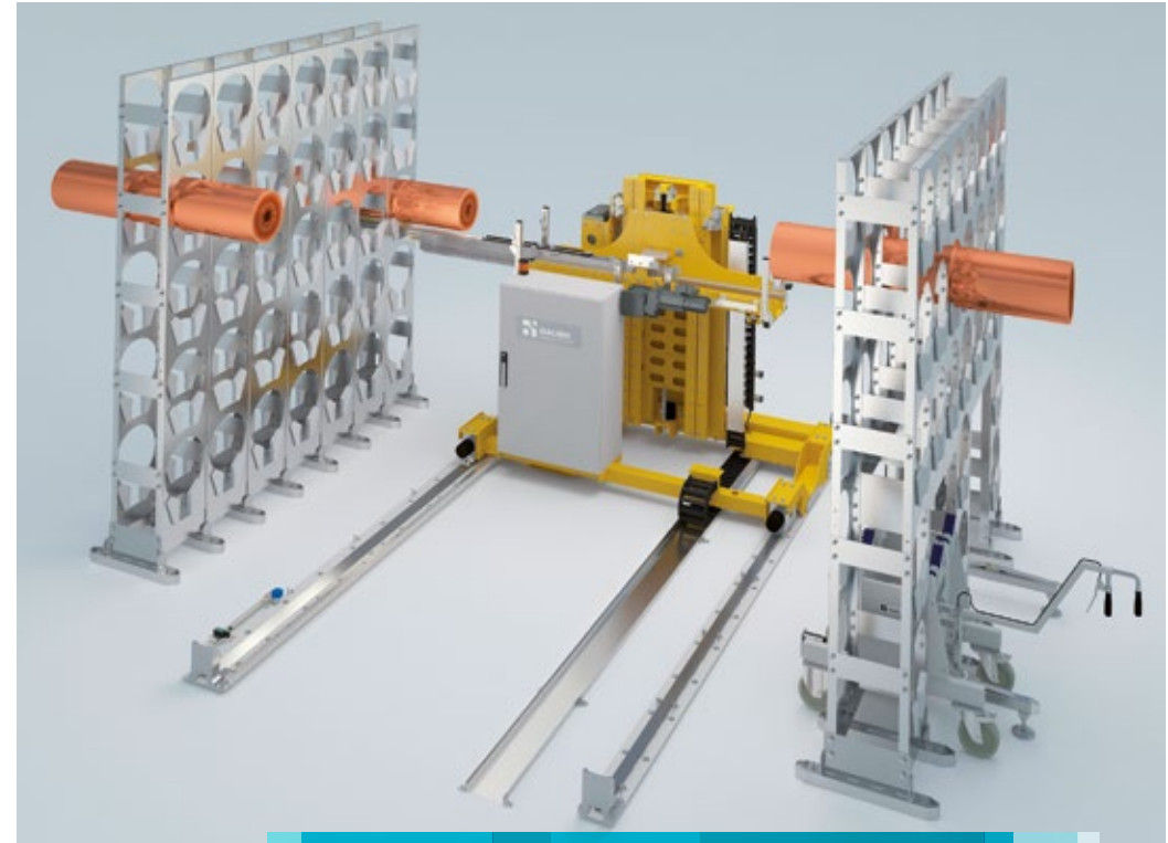
Rail-guided retrieval unit for access to both sides of the rack Regalbediengerät auf Schienen für beidseitigen Zugriff in der Regalgasse
